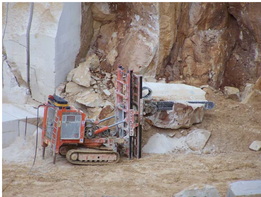
Figure 4 : vue sur l'une des rouilleuses utilisée pour l'extraction des blocs
